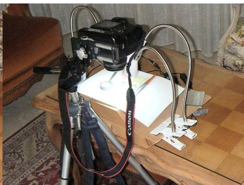
Ce banc est assez simple : Trépied, Chariot de décalage Novoflex, Canon 50D et EF-S 60mm Macro, Spots 12 LED, l'objet est sur une table basse.
