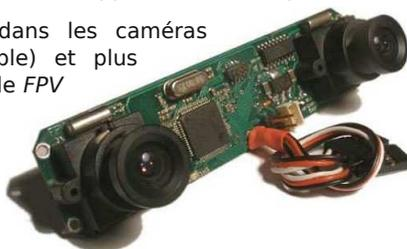
pèse que 23 grammes, est équipé de deux capteurs de 680 x 512 pixels et des objectifs couvrant un champ de 110°. Ce module propose, en plus du format entrelacé, des formats 3D côte-à-côte. Prix : 199 \$US.
