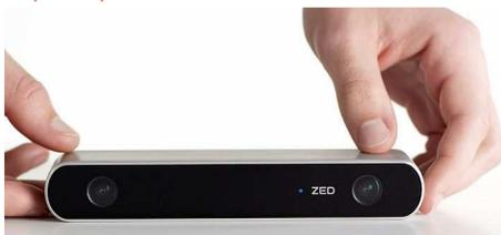
Attention toutefois : ses objectifs grand-angle et sa base stéréo de 12 cm vous donneront un relief non conforme, des images étirées et un effet de maquette, si vous ajustez au montage pour que les arrière-plans à l'infini soient vus à l'infini.
