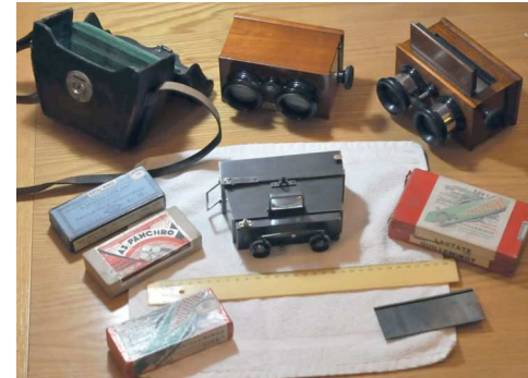
Stéréoscope, Zionscope avec sa sacoche et les boîtes de plaques de petit format.
