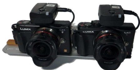
Couplage de deux Panasonic GX1 avec deux objectifs Samyang 7,5 mm fish-eye. Photo : Pierre Meindre
