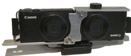
Couplage de deux Canon S95 + télécommande SDM - Photo : Pierre Meindre
