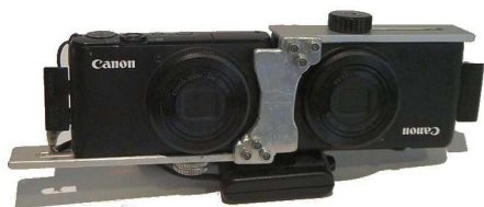
Couplage de deux Canon S95 + télécommande SDM - Photo : Pierre Meindre
