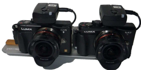
Couplage de deux Panasonic GX1 avec deux objectifs Samyang 7,5 mm fish-eye. Photo : Pierre Meindre
