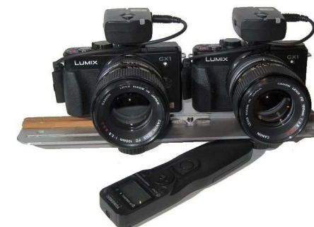
Couplage de deux Panasonic GX1 + télécommande sans fils, les deux récepteurs sont montés sur les griffes flash des appareils. Deux objectifs Canon FD 100 mm f:2.8 sont utilisés ici, ces objectifs "anciens" mais de bonne qualité se trouvent à prix souvent modestes sur les foires à la photo. - Photo : Pierre Meindre
