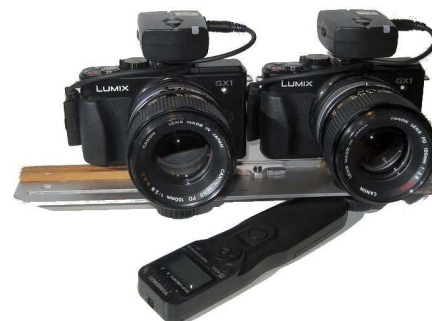
Couplage de deux Panasonic GX1 + télécommande sans fils, les deux récepteurs sont montés sur les griffes flash des appareils. Deux objectifs Canon FD 100 mm f:2.8 sont utilisés ici, ces objectifs "anciens" mais de bonne qualité se trouvent à prix souvent modestes sur les foires à la photo. - Photo : Pierre Meindre
