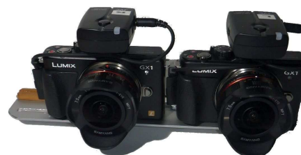
Couplage de deux Panasonic GX1 avec deux objectifs Samyang 7,5 mm fish-eye. Photo : Pierre Meindre
