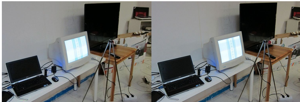
Le système de mesure de la synchronisation : un écran cathodique sur lequel le logiciel SyncTest affiche une mire de mesure - Photo : Thierry Mercier
