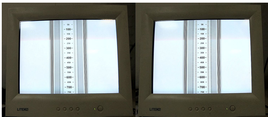
Résultat obtenu pour une synchronisation « quasi parfaite » : le balayage de l'écran est à la graduation 210 sur les deux clichés - Photo : Thierry Mercier
