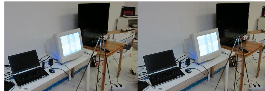
Le système de mesure de la synchronisation : un écran cathodique sur lequel le logiciel SyncTest affiche une mire de mesure - Photo : Thierry Mercier
