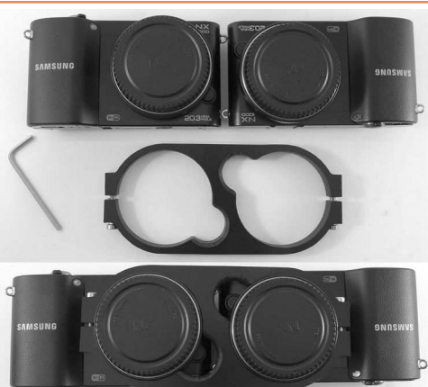
La monture de Werner Bloos permet un montage très compact - Photo : George Themelis
