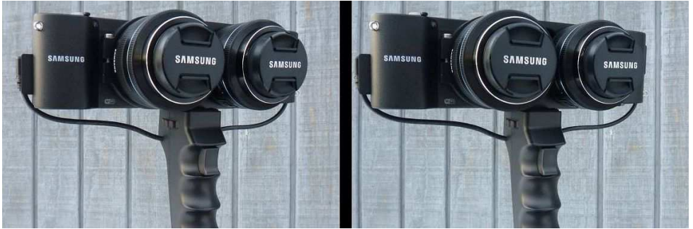
Le couplage de Bill Costa (USA) avec une poignée incorporant un déclencheur.
