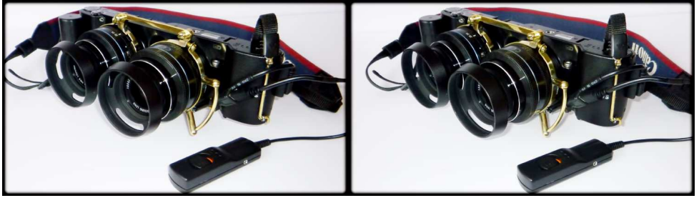
Le couplage de Timo Puhakka (Canada), notez le système de couplage des zooms.
