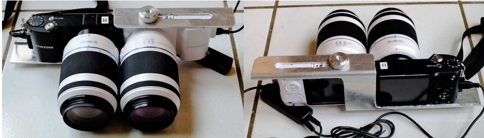
Le couplage de Laurent Doldi de deux Samsung NX1000 avec des zooms 50-200 mm.
