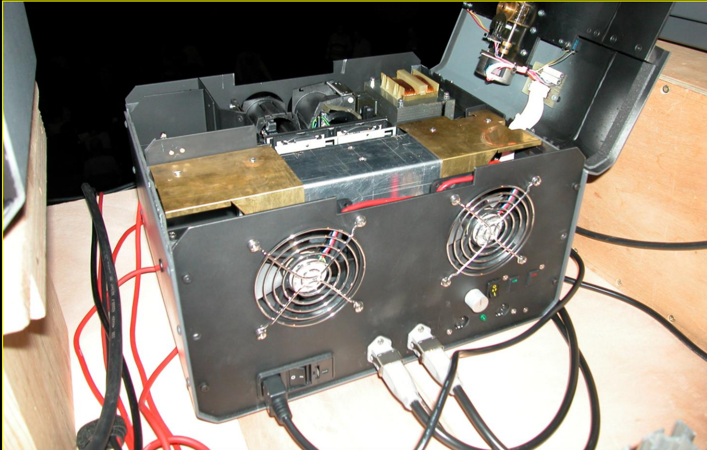
Le prototype du nouveau projecteur RBT 400 W à lampes HMI à peine plus imposant que son petit frère le RBT 101 SUPER. L'alimentation à découpage n'est pas montrée sur cette photo.
