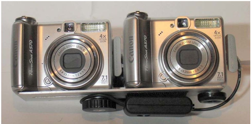
Un couplage simple (et efficace) de deux Canon A570 utilisant le logiciel SDM. Un tel montage revient aux environs de 300-350 € tout compris.
